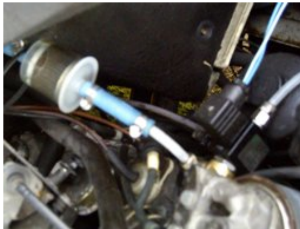
Gambar Converter Kit Yang Telah Terpasang Pada Mesin Diesel
